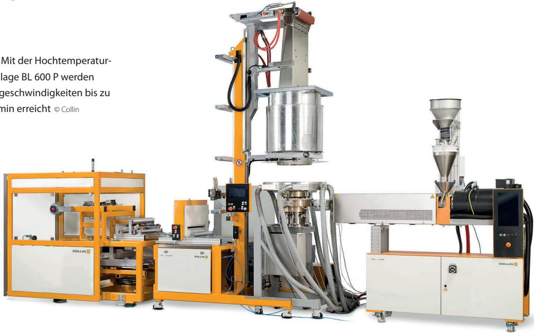
mittelbar an die HT-Düse (bis 450 °C) anschließt (Bild 2). Sie besteht aus zwei elektrisch beheizten Backen, welche den Kaschierspalt bilden. Über Stell-schrauben kann der Spalt exakt eingestellt werden.
