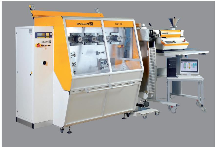
**Bild 6.** Bei der Multifilamentanlage bilden Extrusionsteil, Kühlschacht und die Reckeinheit eine wirtschaftliche und kompakte Einheit © Collin
