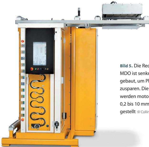
**Bild 5.** Die Reckanlage MDO ist senkrecht aufgebaut, um Platz einzusparen. Die Reckspalte werden motorisch von 0,2 bis 10 mm eingestellt © Collin
