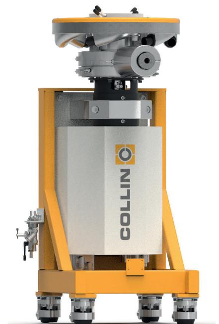
**Bild 4.** Düse für Hochleistungs-Blasfolien: Eine zusätzliche Querkomponente der Orientierung wird dadurch erreicht, dass Dorn und Mundstück rotieren © Collin
